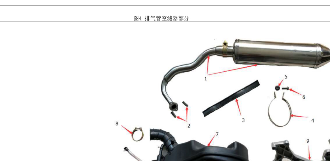
图4 排气管空滤器部分
